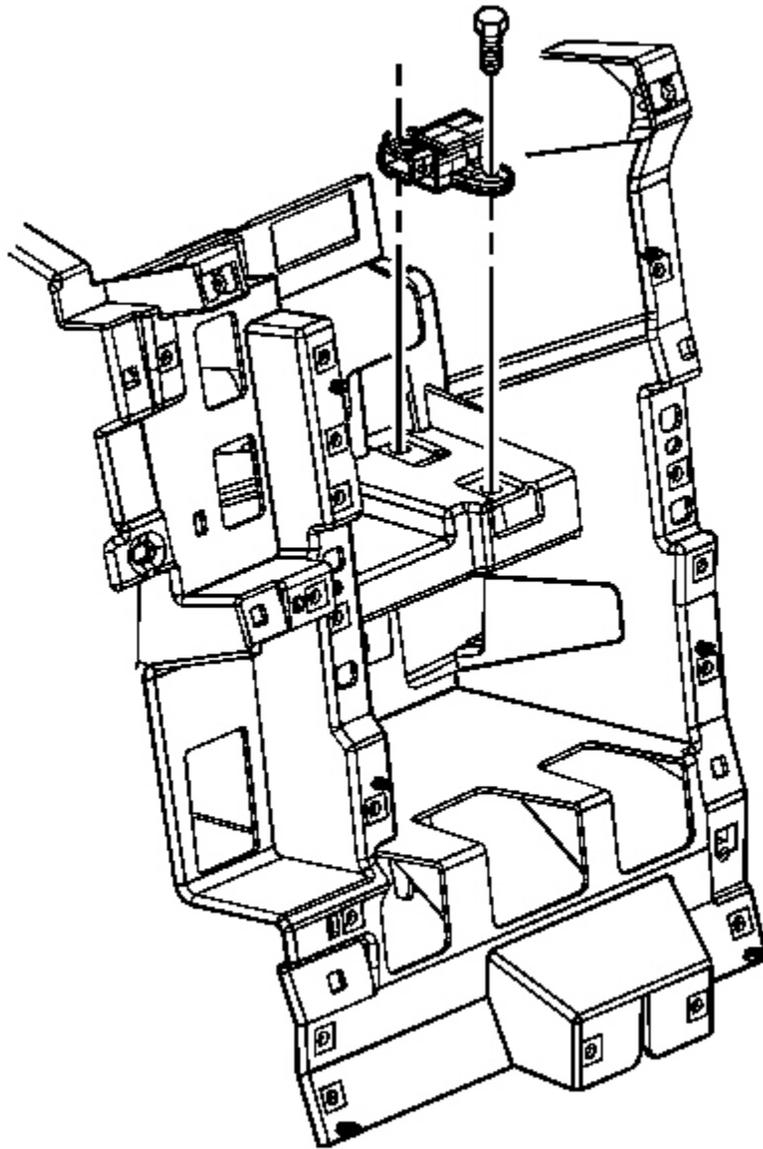
**Fig. 21: Longitudinal Accelerometer**
